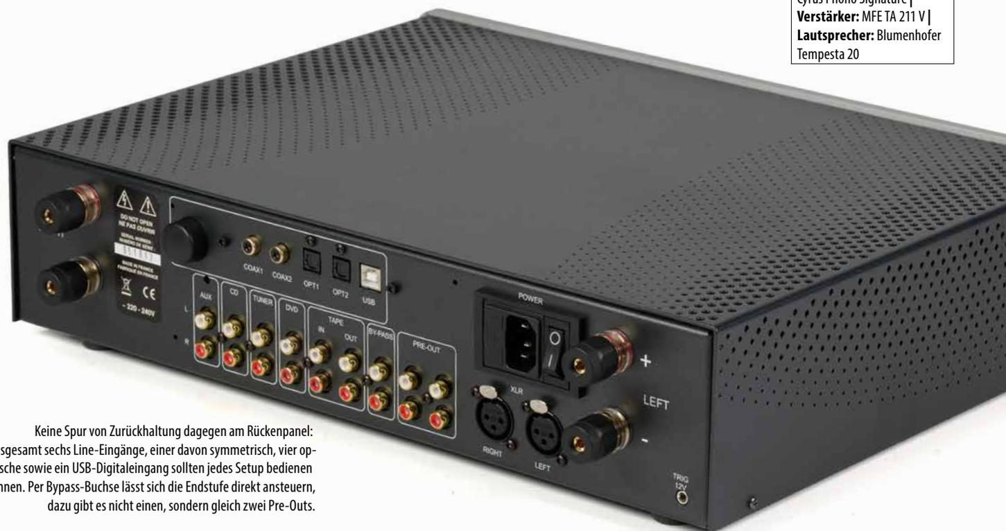
Keine Spur von Zurückhaltung dagegen am Rückenpanel: Insgesamt sechs Line-Eingänge, einer davon symmetrisch, vier optische sowie ein USB-Digitaleingang sollten jedes Setup bedienen können. Per Bypass-Buchse lässt sich die Endstufe direkt ansteuern, dazu gibt es nicht einen, sondern gleich zwei Pre-Outs.
