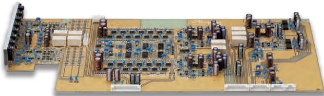
Platine mit "Balanced AAVA"-Lautstärkeregelung
