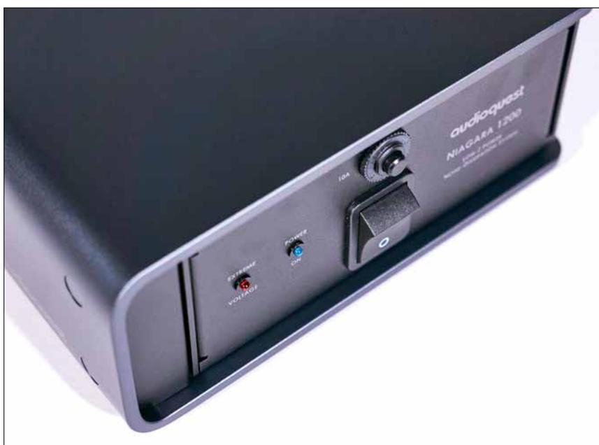
1 Gigahertz verantwortlich, kommt deswegen nur an den fünf Quellgerätschlüssen zum Einsatz. Allen Netzbuchsen zuteil wird dagegen Powells „Ground Noise-Dissipation System“. Mit dieser patentierten Methode zur induktiven Filterung von Störungen auf dem Masseleiter soll eine Modulation des Nutzsignals durch hochfrequente Einstreuungen verhindert werden.
