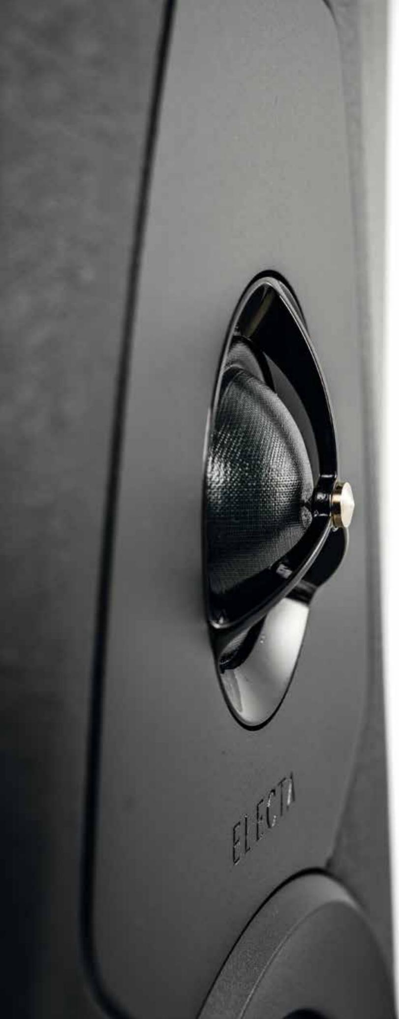
È dotato di un Tweeter a cupola in seta da 28 mm caratterizzato dalla tecnologia DAD™ – Damped Apex Dome™; questa tecnologia rappresenta la sintesi definitiva tra le caratteristiche di dispersione della membrana a cupola e di estensione dei ring tweeter. Il "Damped Apex Dome" infatti previene le risonanze ed i movimenti in controfase dell'apice della cupola morbida attraverso uno smorzamento locale del diaframma.
